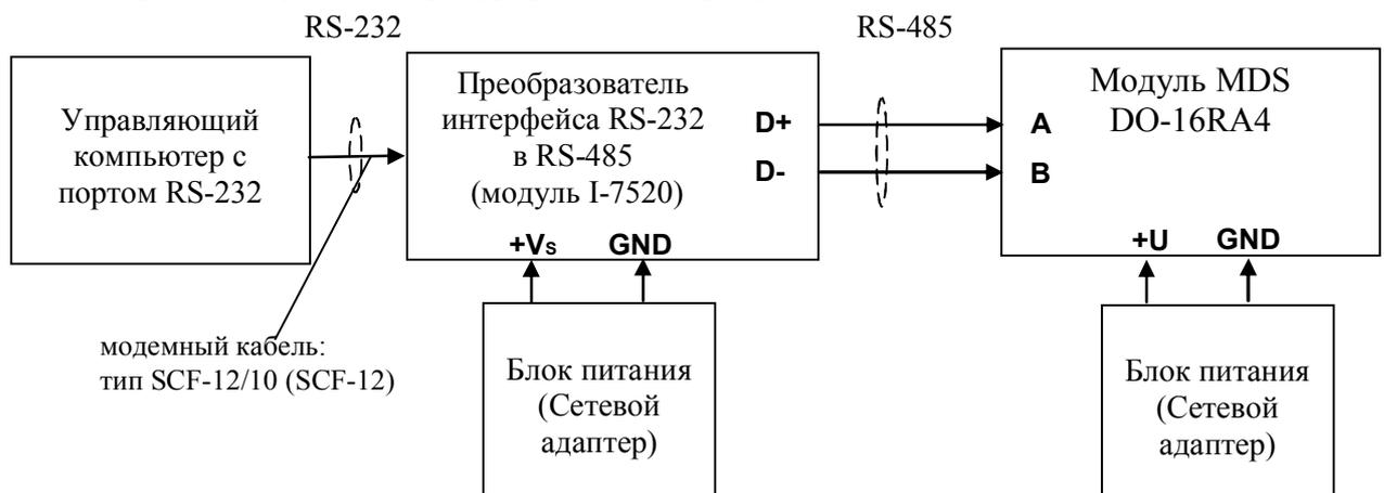
Рисунок 6.1 – Схема подключения модуля для режима работа
