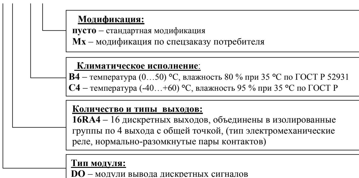
**Пример обозначения при заказе: Модуль ввода–вывода MDS DO-16RA4-C4** Модуль вывода дискретных сигналов, 16 дискретных выходов (тип электромеханическое реле, нормально-разомкнутые пары контактов, 4 группы по 4 выхода с общей точкой), группа климатического исполнения С4, стандартная модификация.
