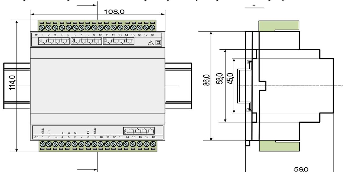
Рисунок 5.1 – Габаритные и присоединительные размеры модуля
