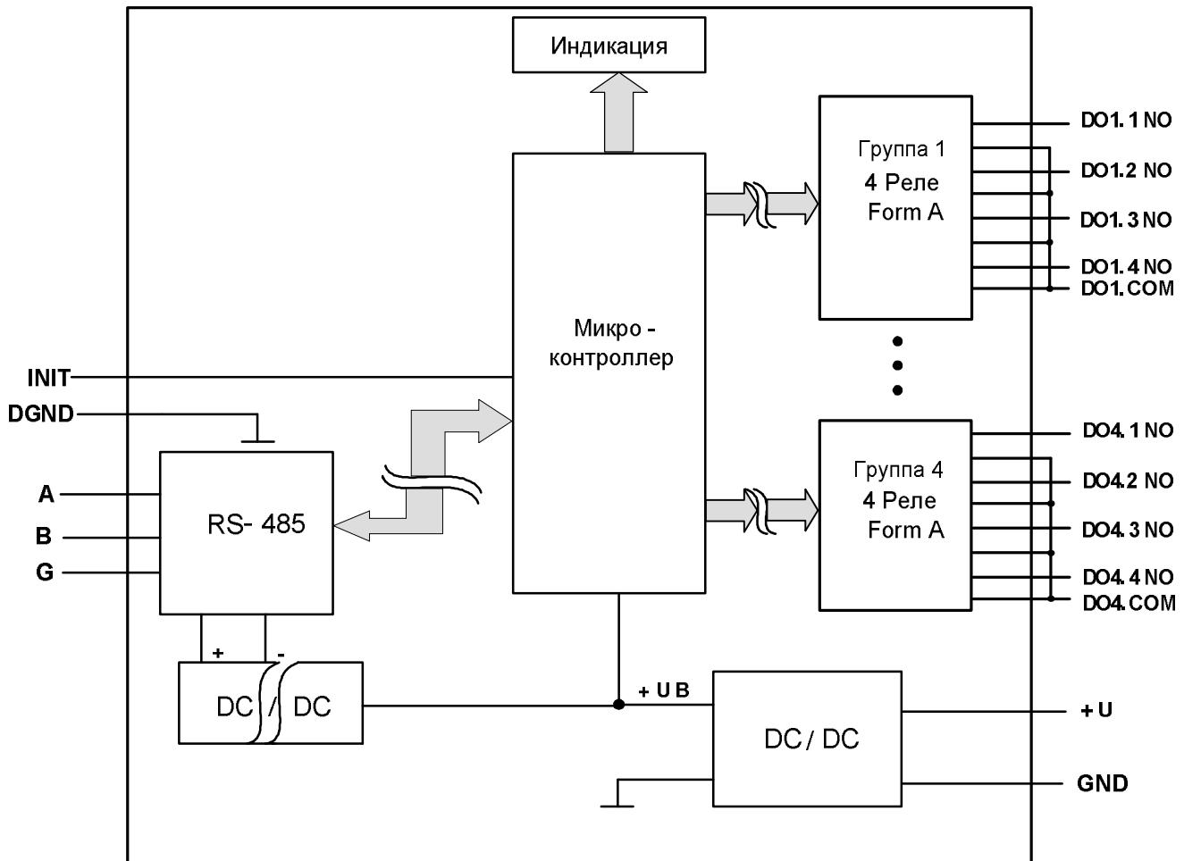
Рисунок 4.2 – Функциональная схема модуля MDS DO-16RA4
