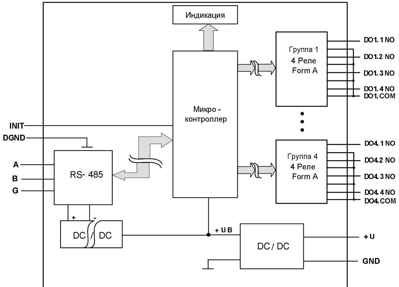
Рисунок 4.2 – Функциональная схема модуля MDS DO-16RA4
