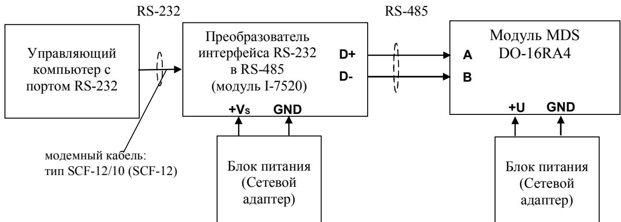
Рисунок 6.1 – Схема подключения модуля для режима работы
