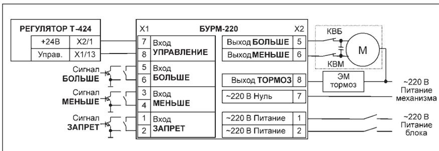
В комплекте с регуляторами, формирующими отдельные сигналы управления (трёхпроводная линия), блок БУРМ-220 преобразует эти сигналы управления в состояние бесконтактных ключей, обеспечивающих непосредственное подключение реверсивных исполнительных устройств. В этом случае блок БУРМ-220 работает как усилитель
