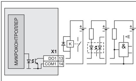
Подключение цепей дискретных выходов DIO-4/4R (электро-механические реле)
