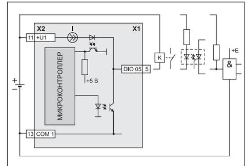
Подключение модуля в промежуточную точку сети
