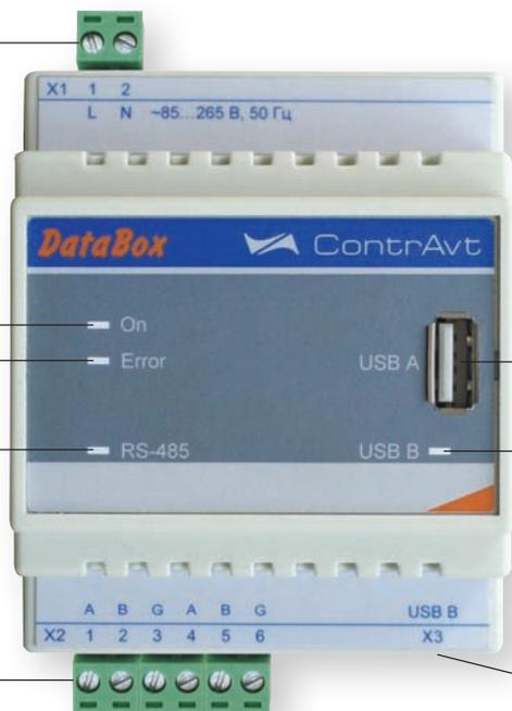
USB-порт для подключения USB flash носителя (только для переноса данных)
