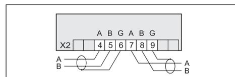
Подключение на конце линии терминального резистора 120 Ом
