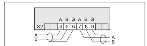
Подключение на конце линии терминального резистора 120 Ом
