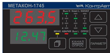
Индикаторы Вых Н, Комп L, КАНАЛ отображают состояние соответствующих выходов
