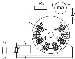
4-х проводная схема подключения ТС
