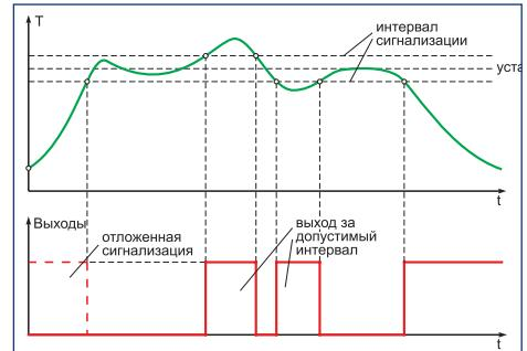
Режим задержки срабатывания компаратора исключает ложные переключения при кратковременном выходе параметров за допустимые пределы
