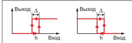
Работа компаратора: прямая функция без защёлки
