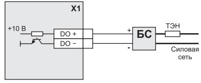
Применение транзисторного ключа в качестве активного ключа для управления блоком симисторным БС или твердотельным реле
