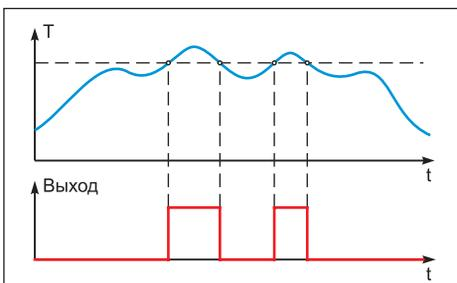
Работа компаратора: прямая функция с защёлкой
