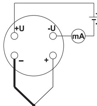
Питание и выходной сигнал передаются по токовой петле с применением 2-х проводной линии.
