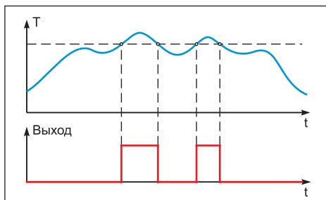
Работа компаратора прямая с функцией защелки
