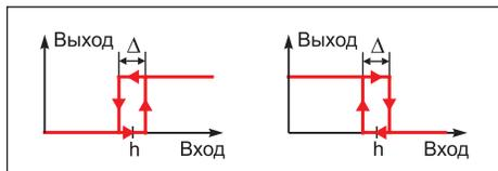
Работа компаратора: прямая функция без защёлки
