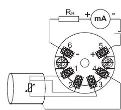
3-х проводная схема подключения ТС
