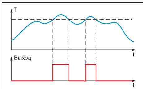
Работа компаратора прямая с функцией защёлки
