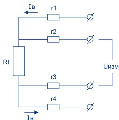
Четырехпроводная схема подключения термометров сопротивления
