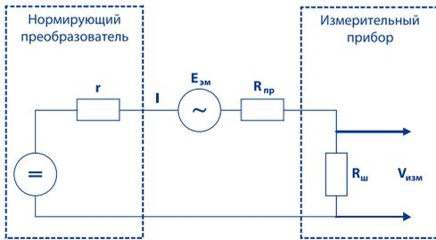
Нормирующий преобразователь, который формирует токовый сигнал 4...20 мА, является так называемым генератором тока – источником стабильного тока с очень большим выходным сопротивлением:  $r \gg R_{ш}, R_{пр}$ , где  $r$  – дифференциальное выходное сопротивление нормирующего преобразователя,  $R_{ш}, R_{пр}$  – соответственно сопротивления шунта в измерительном приборе и соединительных проводов.
