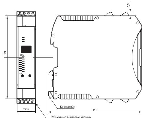
Уровень выходного сигнала (в %) отображается на цифровом дисплее и на линейной шкале (бар-графе). Это позволяет без привлечения дополнительных средств измерений оценивать уровни сигналов при пуско-наладочных работах и при обслуживании систем.
