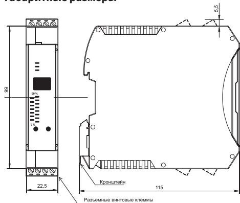
Уровень выходного сигнала (в %) отображается на цифровом дисплее и на линейной шкале (бар-графе). Это позволяет без привлечения дополнительных средств измерений оценивать уровни сигналов при пуско-наладочных работах и при обслуживании систем.
