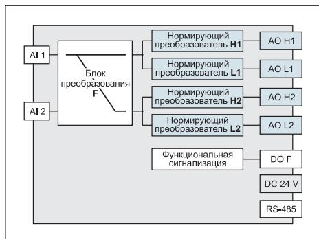
Прямое и обратное преобразование измеренного сигнала
