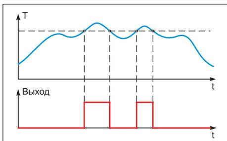
Работа компаратора: прямая функция с защёлкой
