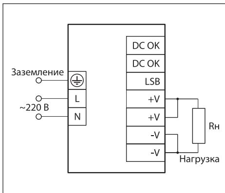
■ Импульсный источник стабилизированного напряжения 24 В
