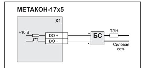
Применение транзисторного ключа в качестве активного ключа для управления блоком симисторным БС или твердотельным реле
