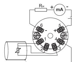
3-х проводная схема подключения ТС
