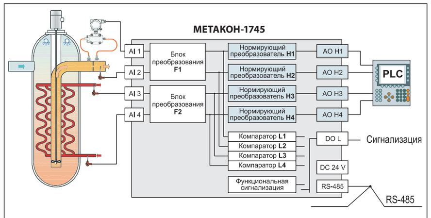
**Двухканальная ретрансляция измеренных сигналов с разветвлением «1 в 2»**
