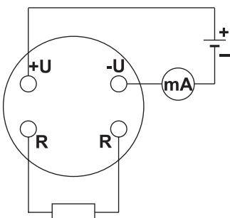
Питание и выходной сигнал передаются по токовой петле с применением 2-х проводной линии.
