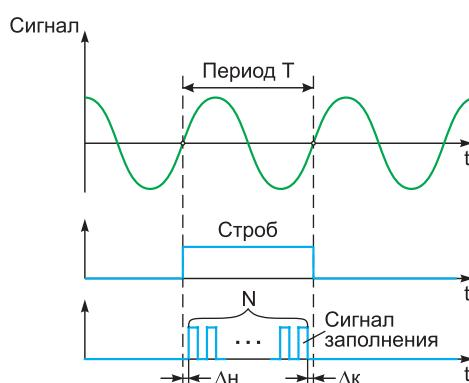
Соотношение для расчета относительной погрешности измерения периода показывает, что при измерении по одному периоду сигнала нужно использовать сигнал заполнения, частота которого значительно превосходит частоту измеряемого сигнала. Например, если мы хотим измерять частоту сигнала до  $10 \text{ кГц} = 10^4 \text{ Гц}$  с относительной погрешностью 0,01 %, то частота заполнения должна быть не менее  $100 \text{ МГц} = 10^8 \text{ Гц}$ .
