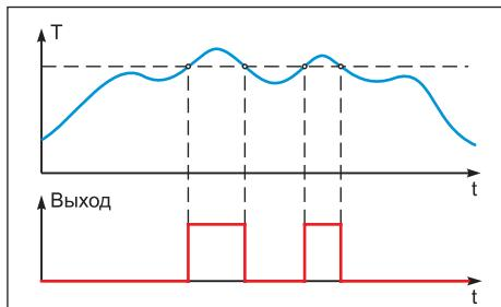
Работа компаратора: прямая функция с защёлкой
