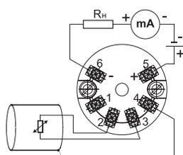
2-х проводная схема подключения ТС
