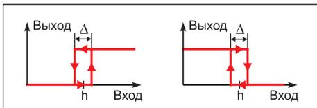
Работа компаратора: прямая функция без защёлки
