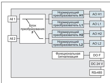
Прямое и обратное преобразование измеренного сигнала
