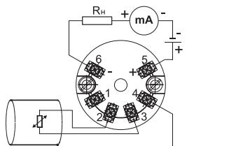
2-х проводная схема подключения ТС
