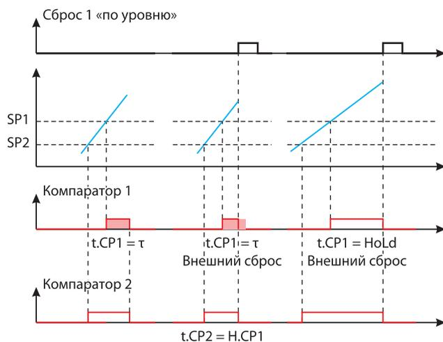
Если компаратор 2 подключен к текущему счетчику ( $S.CP2 = Count$ ), то параметр время удержания компаратора 2  $t.CP2$ , кроме прежних значений от 0 до 999,9 с или  $HoLd$ , может принимать дополнительное значение  $H.CP1$ . При  $t.CP2 = H.CP1$  компаратор 2 после срабатывания удерживается неограниченно долго до сброса задним фронтом компаратора 1.
