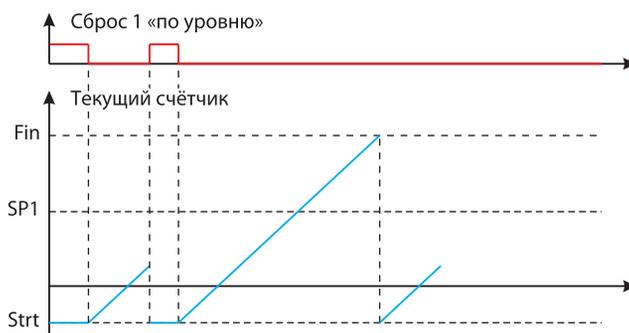
**F.Cnt = Fin.CP1** – текущий счётчик считает до границы **Fin** и остаётся там неограниченно долго до сброса задним фронтом компаратора 1 или до внешнего сброса
