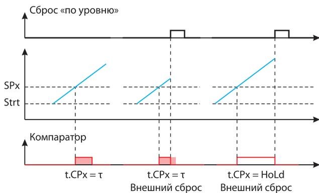
Источником сигнала для компаратора 1 всегда является текущий счётчик. Источниками сигнала для компаратора 2 могут быть текущий счётчик, общий счётчик и счётчик групп.
