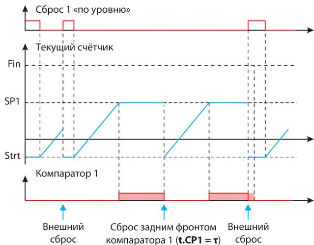
$F.Cnt = SP1.CP1$  – текущий счётчик считает до уставки  $SP1$  и остается там неограниченно долго до сброса задним фронтом компаратора 1 или до внешнего сброса
