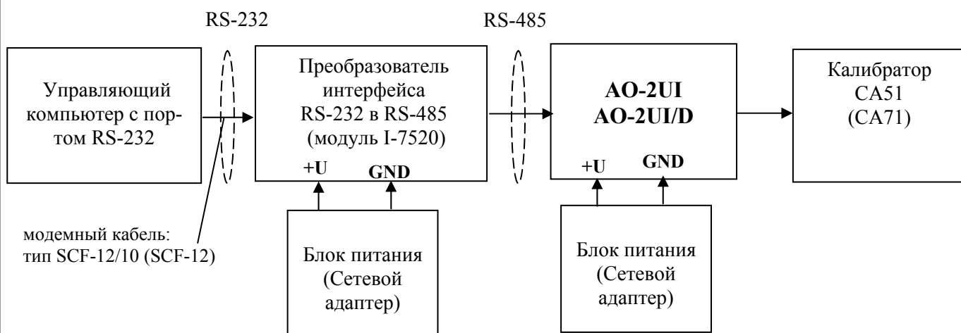
Рис.П6.3.4 Схема соединений при проверке основной погрешности выходных каналов модуля для постоянного напряжения и тока.
