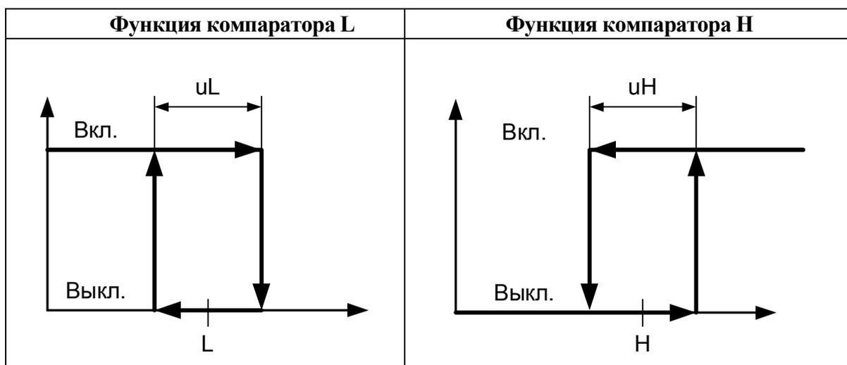
Рисунок 6 – Функции компараторов **H** и **L**
