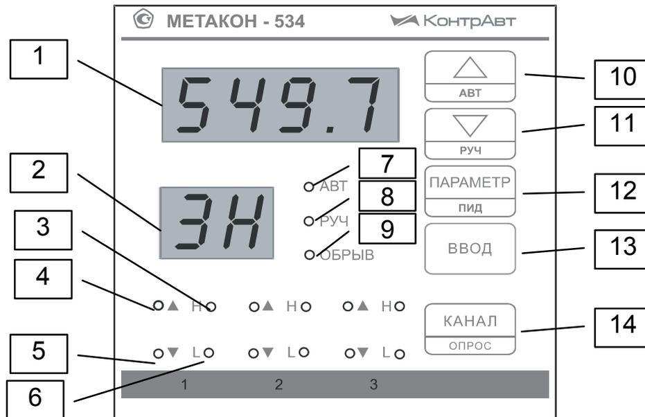
Рисунок 23 – Лицевая панель приборов серии **МЕТАКОН-534**
