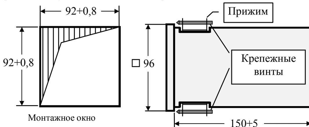
Рисунок 7 – Габаритные и установочные размеры прибора
