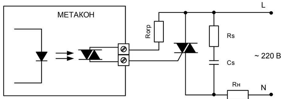
Рисунок 19 – Схема подключения силового симистора к выходу «С»
