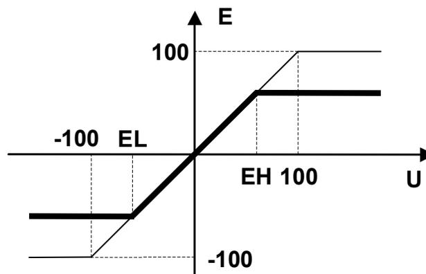
Рисунок 3 – Принцип ограничения выходного сигнала **U** регулятора
