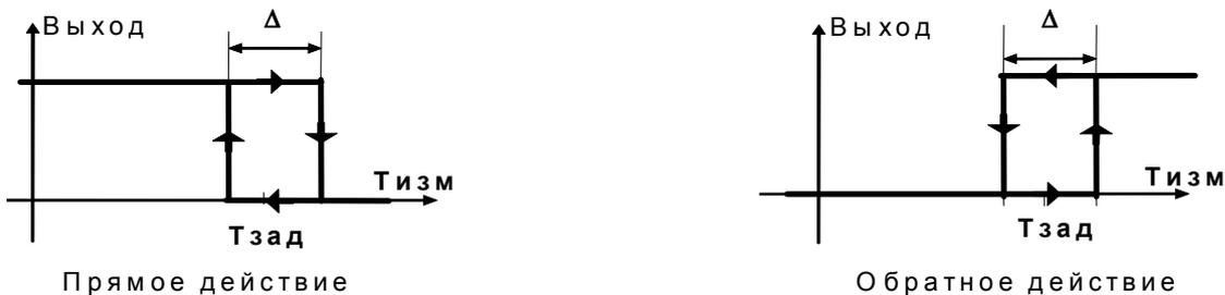
Выходной сигнал компаратора **SP** управляет транзисторным ключом и реле **RSP**.
