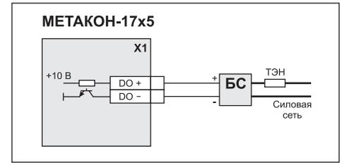
Применение транзисторного ключа в качестве активного ключа для управления блоком симисторным БС или твердотельным реле
