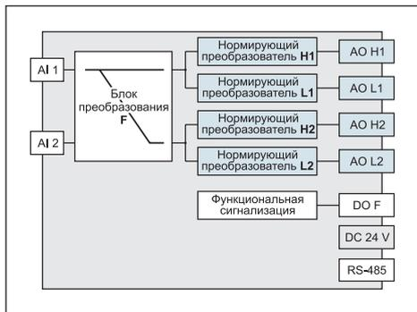
Прямое и обратное преобразование измеренного сигнала
