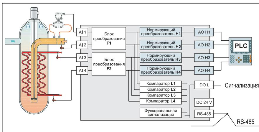
**Двухканальная ретрансляция измеренных сигналов с разветвлением «1 в 2»**
