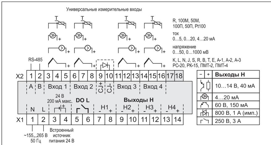
Схема подключения Блока симисторного БС или твердотельного реле к выходам типа К
