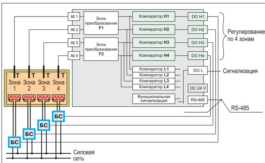
**Двухзонное трехпозиционное регулирование «нагрев-охлаждение»**
