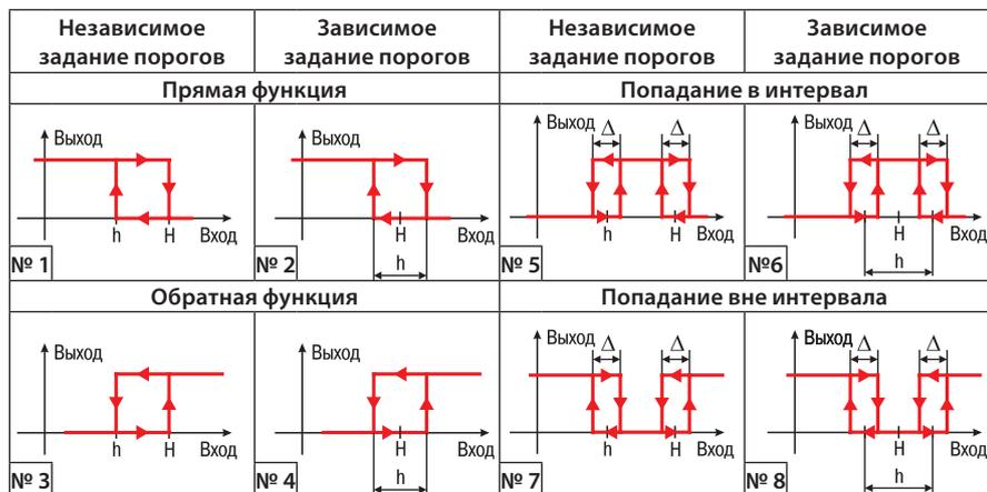
Функции, гистерезис и уставки всех компараторов программируются независимо.
