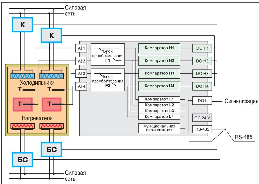
**Двухпозиционное регулирование и трехканальная сигнализация**
