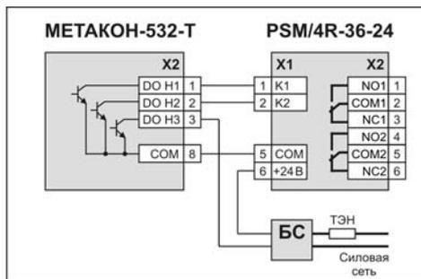
Схема «Монтажное ИЛИ» на выходах типа Т
