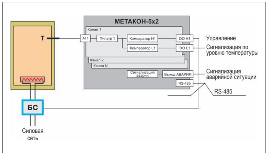
**Многоканальное трехпозиционное регулирование технологических параметров**
