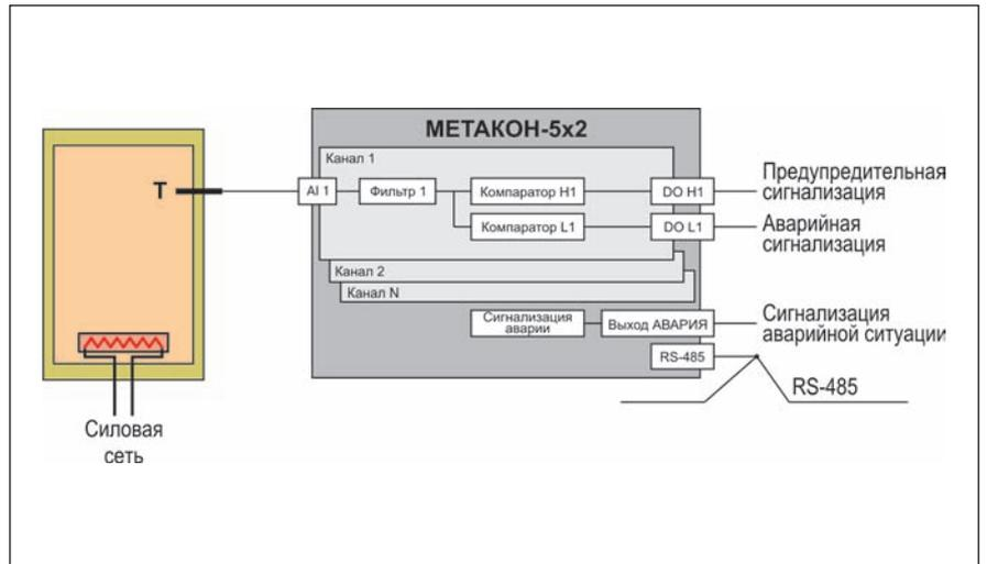
**Многоканальное двухпозиционное регулирование технологических параметров и сигнализация**
