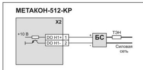
Схема подключения Блока питания и реле PSM/4R-36-24 для реализации сигнализации с защёлкой
