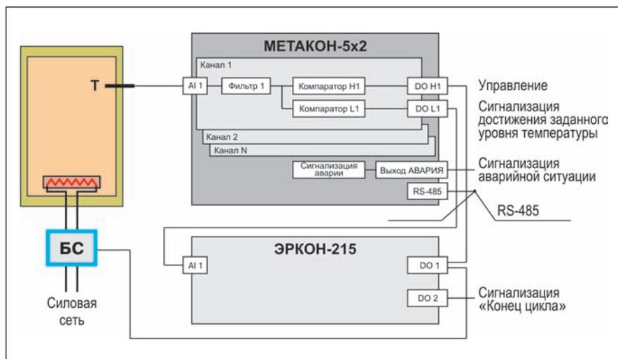
**Многоканальное двухпозиционное регулирование технологических параметров с временной выдержкой**
