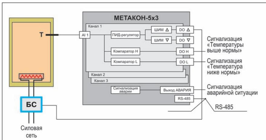
**Регулирование температуры в печи с временной выдержкой при достижении заданной температуры**
