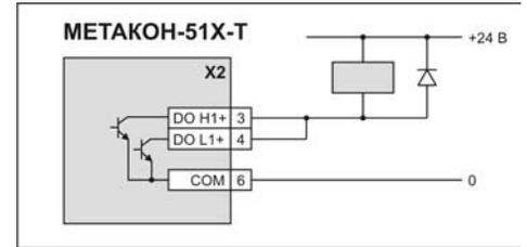
Схема подключения Блока симисторного БС или твердотельного реле к выходам типа К
