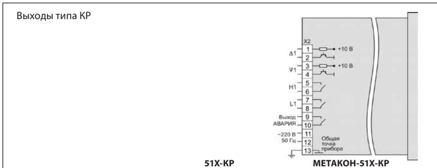
Схемы подключения входных цепей совпадают со схемами подключения регуляторов серии МЕТАКОН-5х2 (см. стр. 40)
