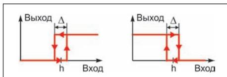
Работа компаратора: прямая функция без защелки
