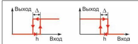
Работа компаратора с функцией защелки
