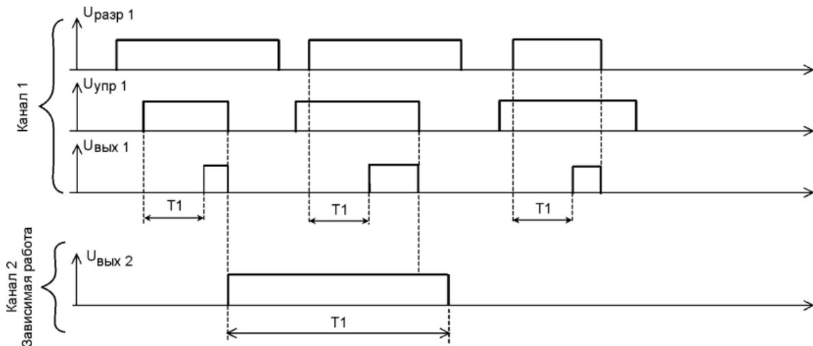
**Пример применения реле с зависимой работой каналов**
