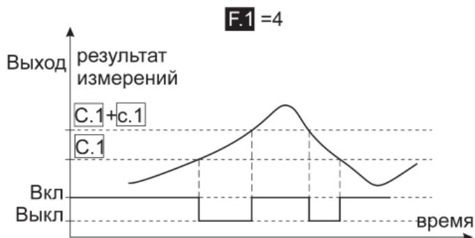
Рисунок 4а – Диаграммы работы компаратора
