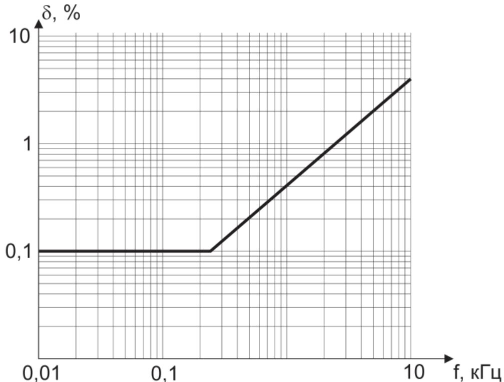
Рисунок 3 – Зависимость точности измерения от частоты
