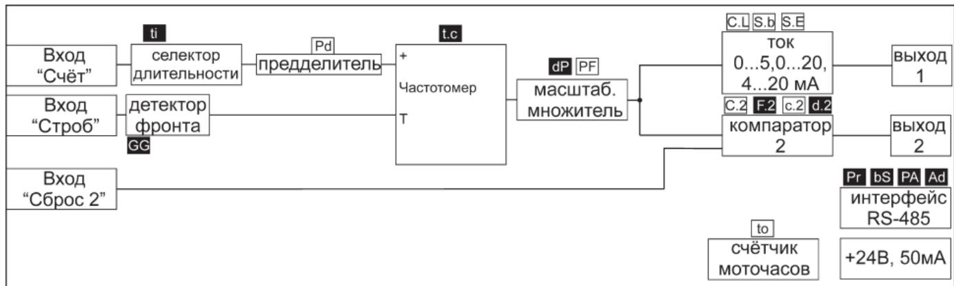
Рисунок 2б – Функциональная структура ЭРКОН-415-220-1Р1У-Х
