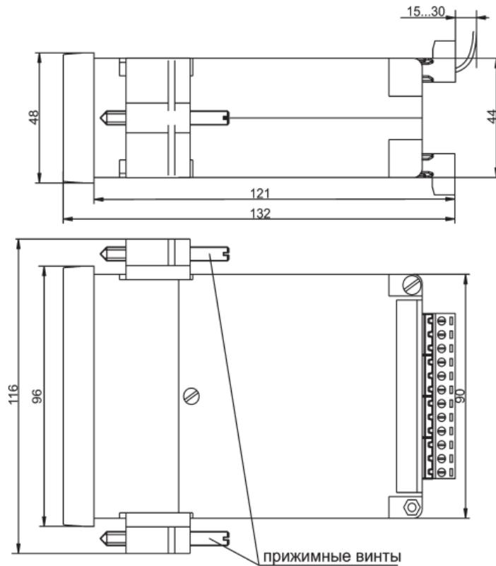
Рисунок 6 – Габаритные размеры
