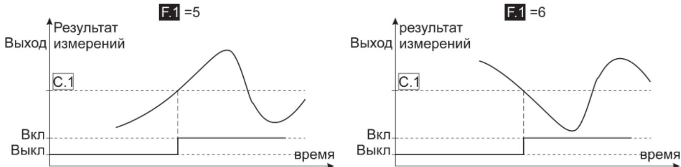
Рисунок 4б – Диаграммы работы компаратора
