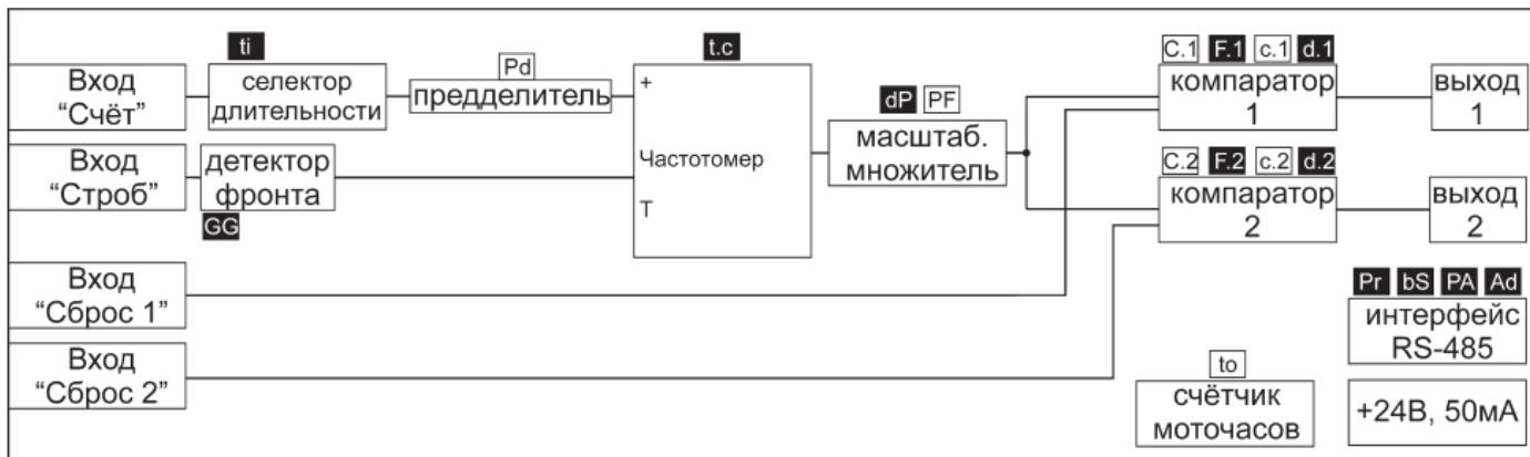
Рисунок 2а – Функциональная структура ЭРКОН-415-220-2Р-Х
