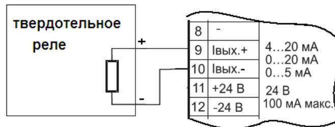
Рисунок 12 - Подключение твердотельного реле к активному (токовому) выходу
