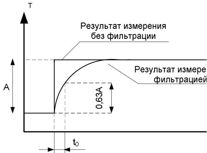
Рисунок 3 - График, показывающий влияние цифровой фильтрации результата измерения
