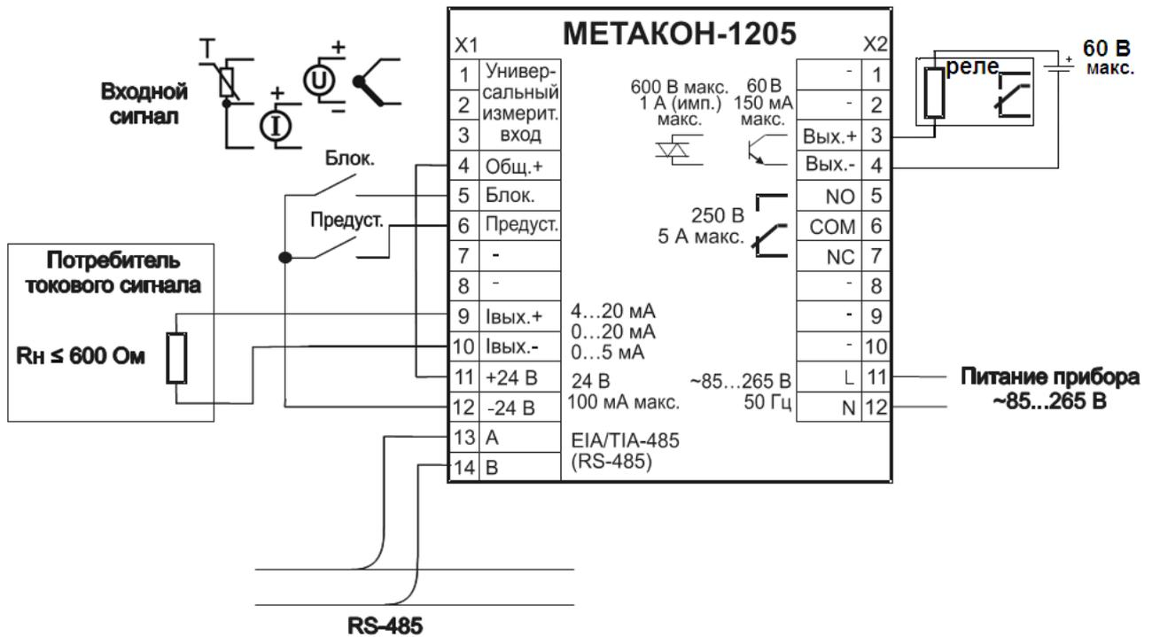
Рисунок 10 - Электрическая схема подключения прибора МЕТАКОН-1205
