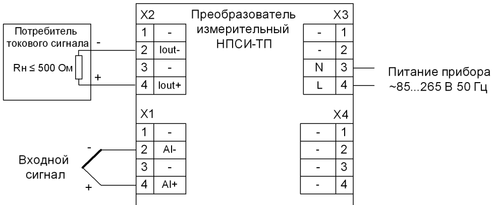
Рисунок 3 – Электрическая схема подключения преобразователя НПСИ-ТП-Х-220-Х
