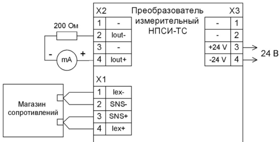
Рисунок 6.3.2.b – Определение основной допускаемой погрешности преобразования преобразователя НПСИ-ТС-X-24-X
