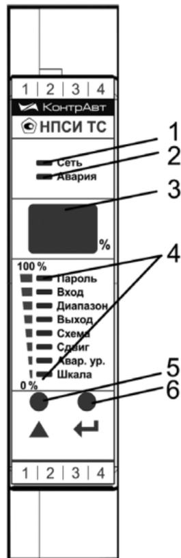
Рисунок 1 – Передняя панель преобразователя
