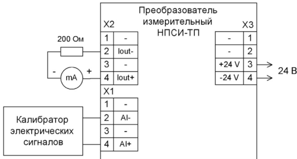
Рисунок 6.3.1.1.b – Схема определения основной допустимой погрешности преобразования преобразователя НПСИ-ТП-Х-24-Х
