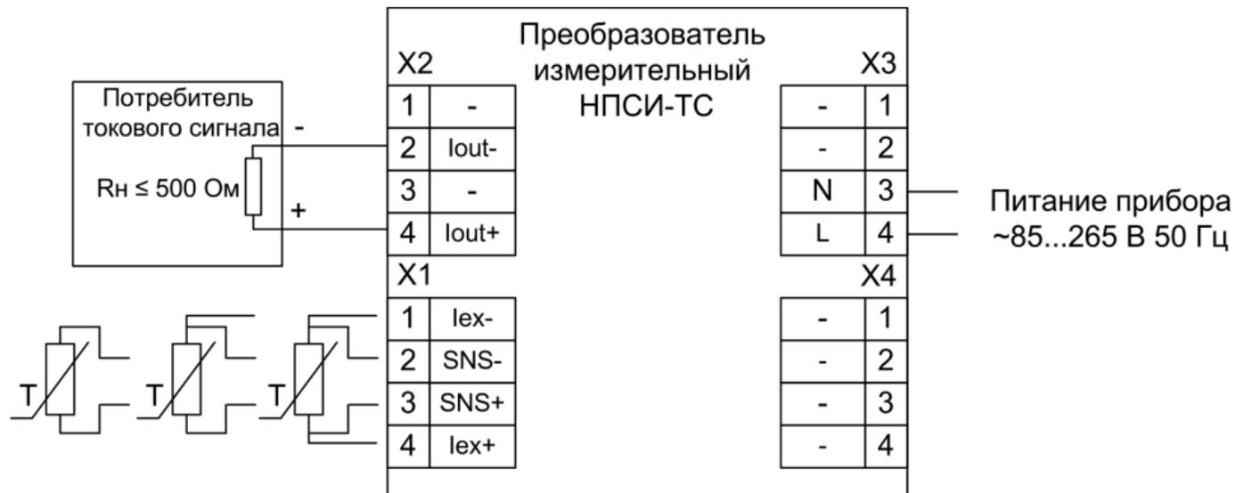
Рисунок 3 – Электрическая схема подключения преобразователя НПСИ-ТС-X-220-X
