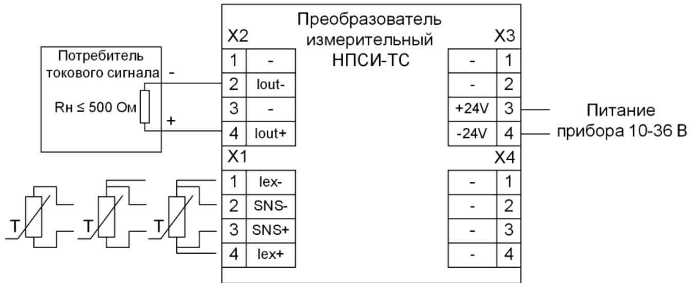
Рисунок 4 – Электрическая схема подключения преобразователя НПСИ-ТС-Х-24-Х
