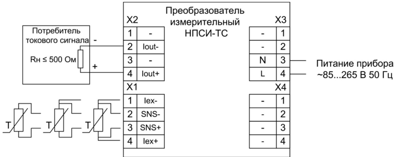
Рисунок 3 – Электрическая схема подключения преобразователя НПСИ-ТС-Х-220-Х
