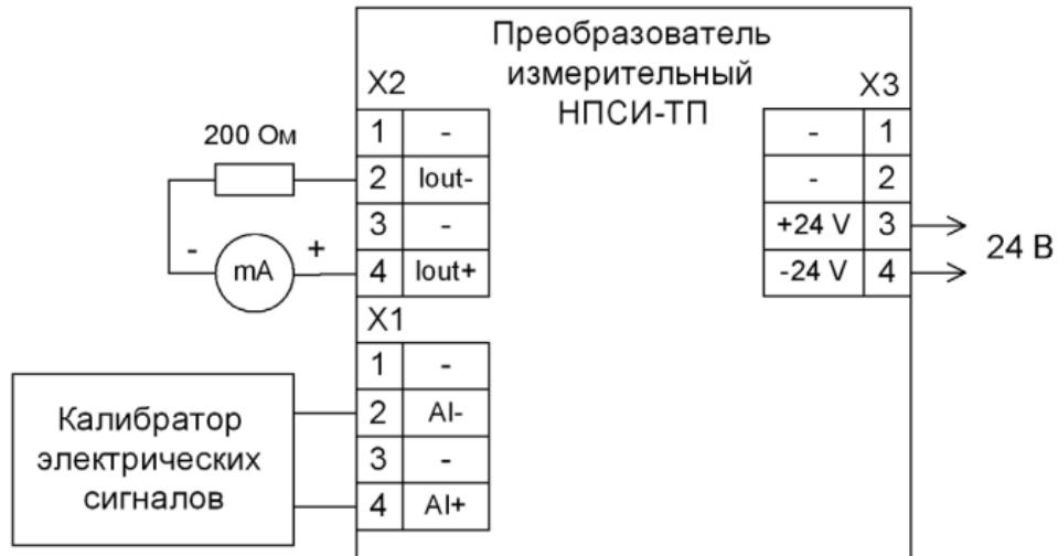
Рисунок 6.3.1.1.b – Схема определения основной допускаемой погрешности преобразования преобразователя НПСИ-ТП-Х-24-Х
