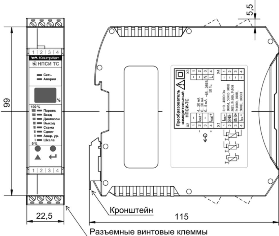
Рисунок 2 – Габаритные размеры преобразователя
