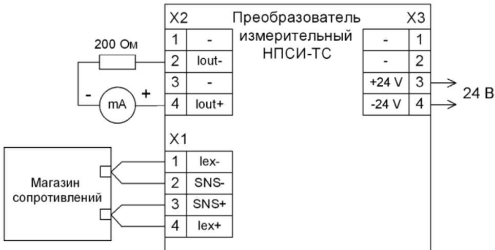
Рисунок 6.3.2.b – Определение основной допускаемой погрешности преобразования преобразователя НПСИ-ТС-Х-24-Х
