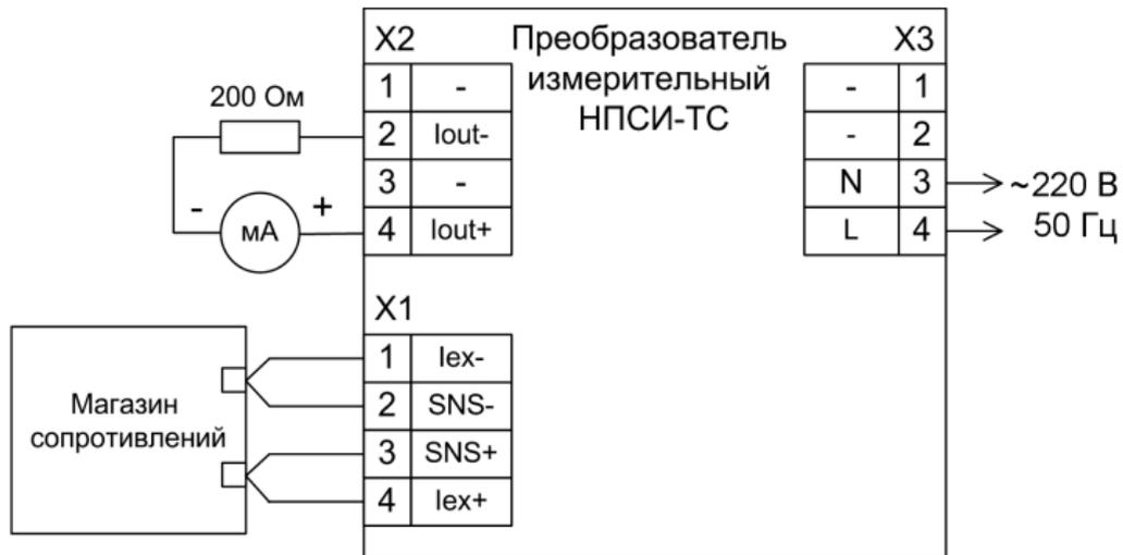
Рисунок 6.3.2.а – Определение основной допускаемой погрешности преобразования преобразователя НПСИ-ТС-Х-220-Х
