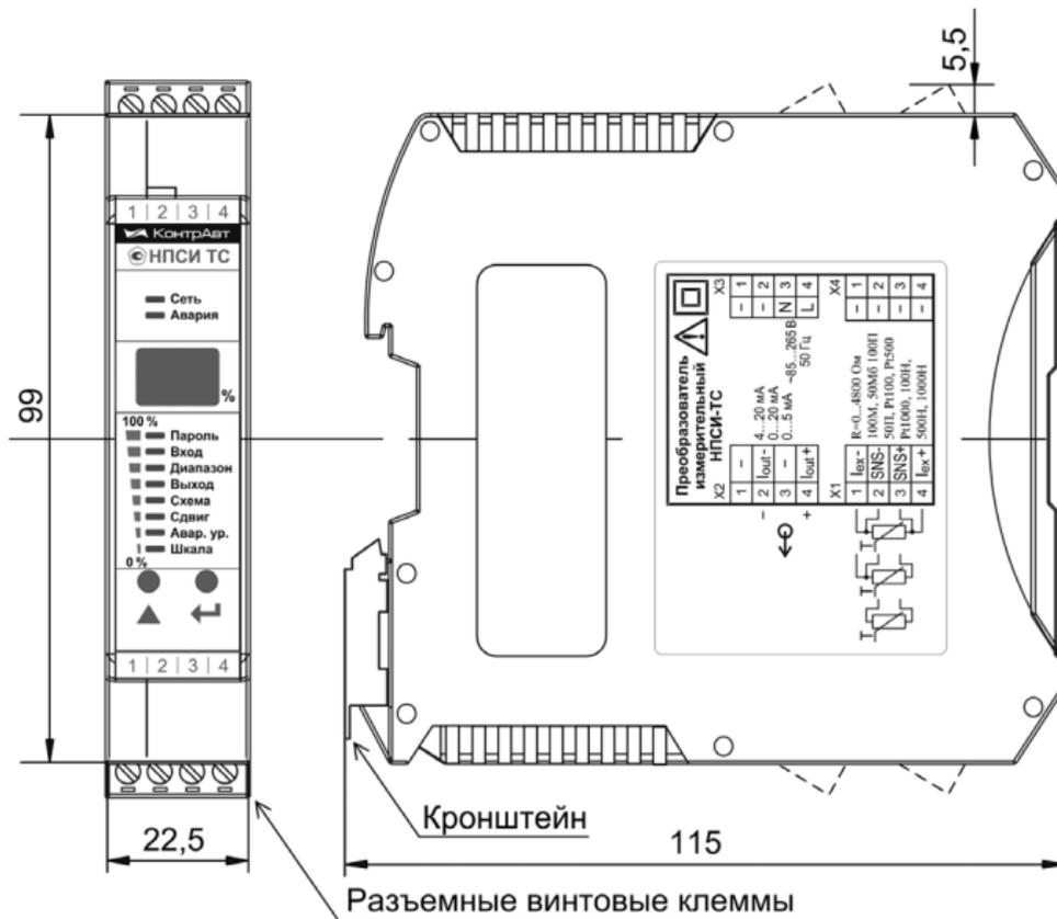
Рисунок 2 – Габаритные размеры преобразователя
