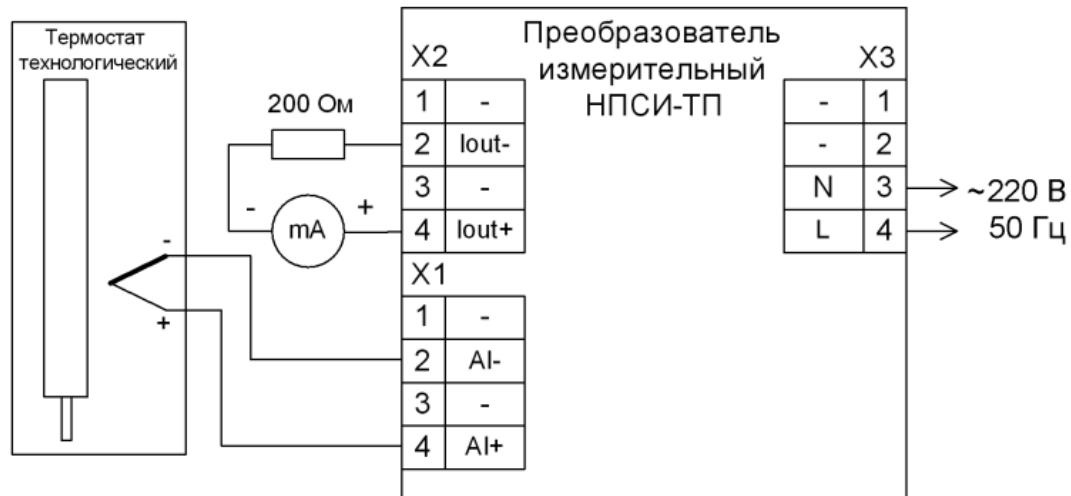
Рисунок 6.3.1.2.а – Схема для определения погрешности термо-ЭДС
