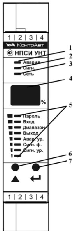
Рисунок 1 – Передняя панель преобразователя
