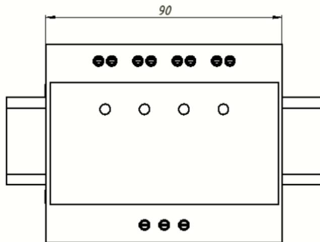
Рисунок 4 – Габаритные размеры блока питания **PSM-4/3-24**
