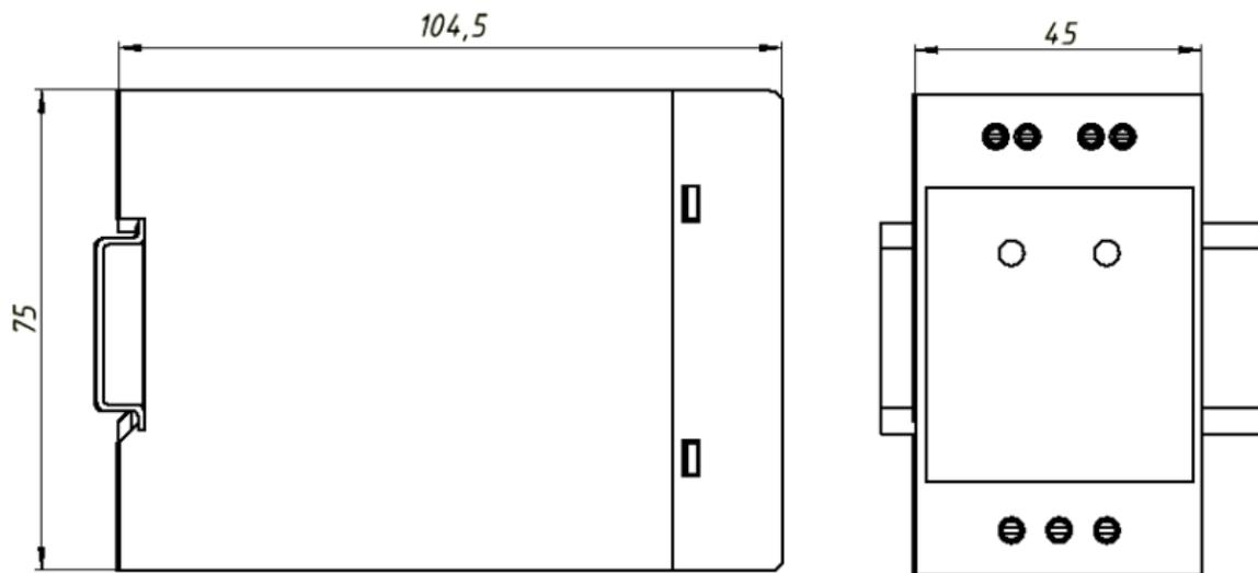
Рисунок 3 – Габаритные размеры блока питания **PSM-2/3-24**
