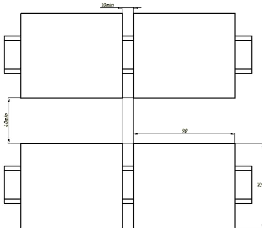
Рисунок 6 – Присоединительные размеры блоков питания **PSM-4/3-24**
