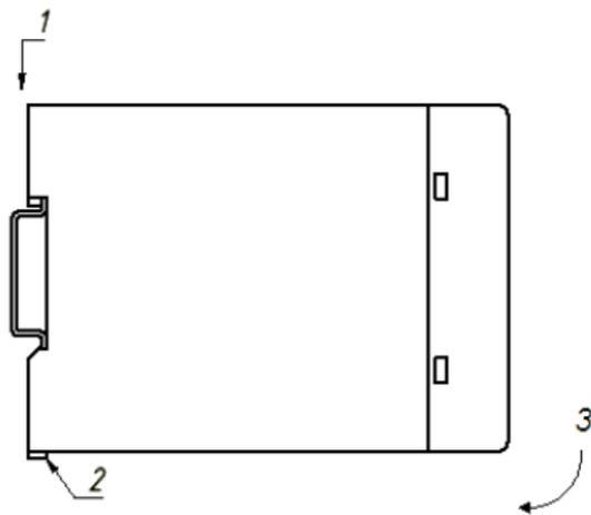
Рисунок 7 – Способ монтажа блоков питания на монтажную шину
