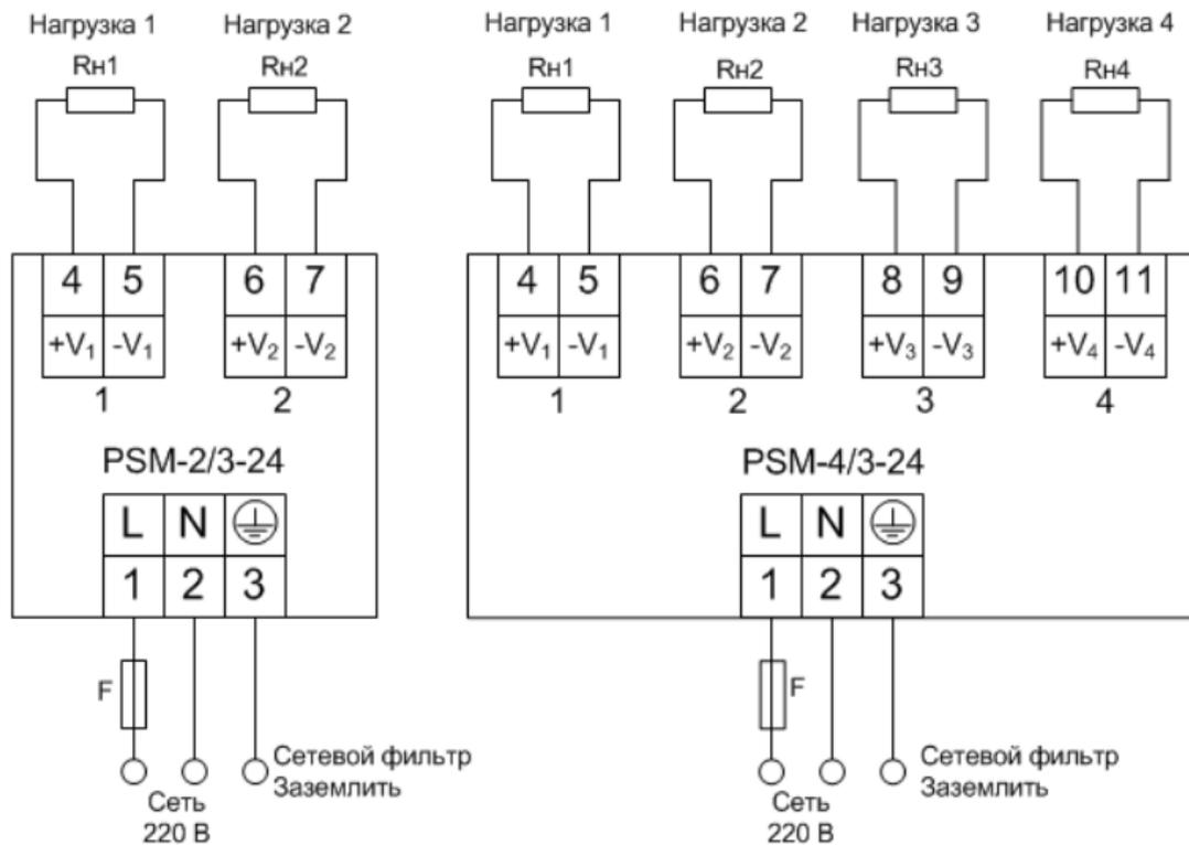
Рисунок 2 – Схема подключения блоков питания
