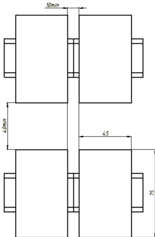
Рисунок 5 – Присоединительные размеры блоков питания **PSM-2/3-24**
