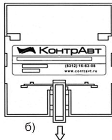
Рисунок 4 – Способы установки блока питания при монтаже
