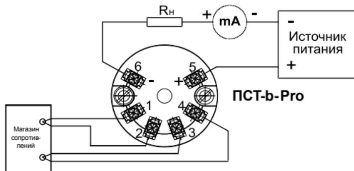
Рисунок А.3 – Схема подключения преобразователя мод. **ПСТ-b-Pro** для проведения поверки
