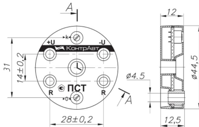
Рисунок 1 – Внешний вид и габаритные размеры преобразователя ПСТ.
