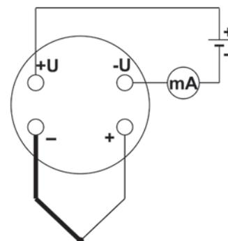
Питание и выходной сигнал передаются по токовой петле с применением 2-х проводной линии.
